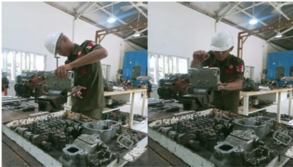
Gambar 5. Praktik pembongkaran pompa injeksi oleh peserta
