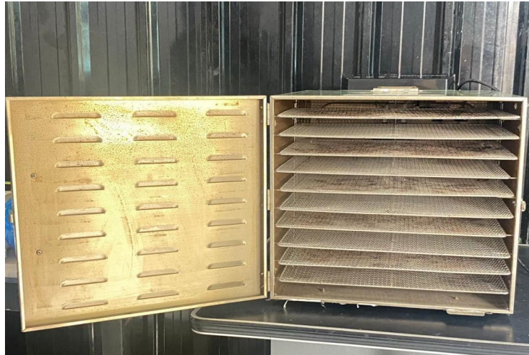
Gambar 1. Proses pengeringan bahan baku dengan menggunakan oven
