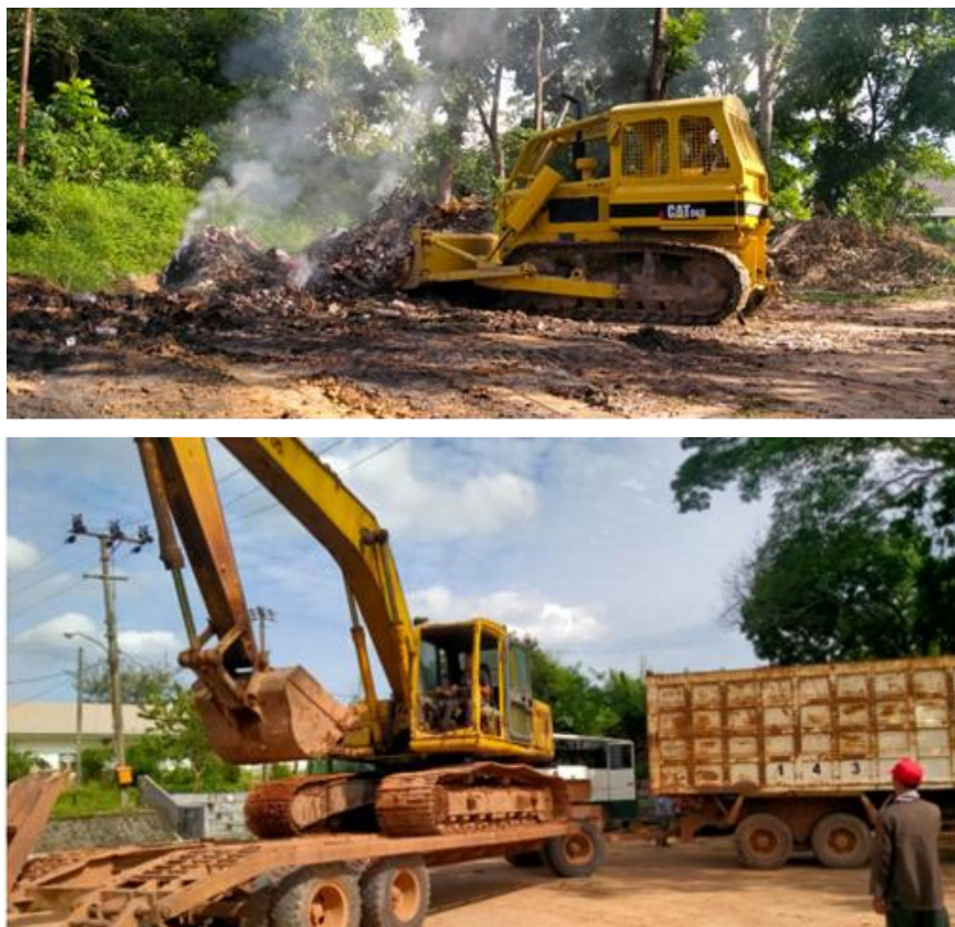
Gambar 7. Modul Praktik Mahasiswa Pemeliharaan Alat Berat: Dozer D6D dan Excavator PC 200 dan Dump Truck yang digunakan untuk penataan dan pembersihan lahan sampah terbuka
