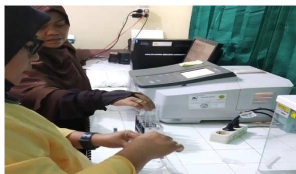
Gambar 3. Proses Analisa Protein dan Karbohidrat Dengan Spektrometer UV-VIS
