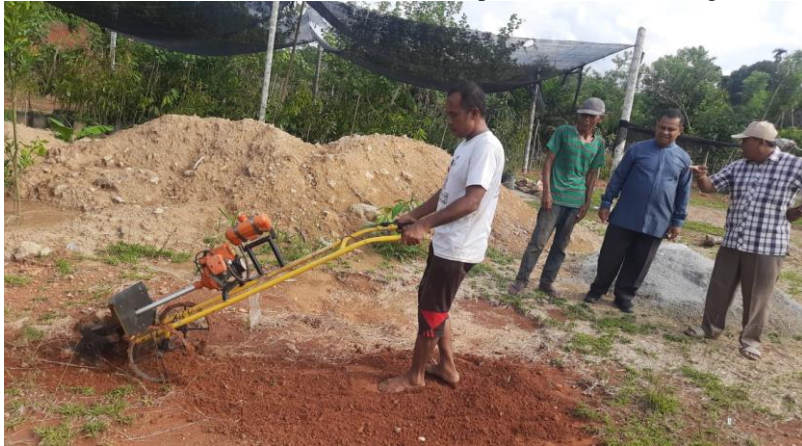
Gambar 6. Implementasi mesin cultivator
