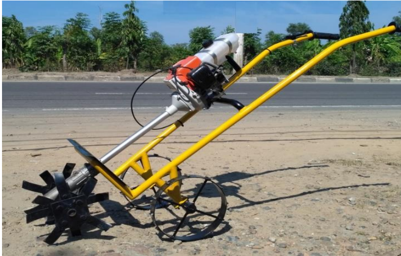
Gambar 3. Mesin cultivator hasil manufaktur
