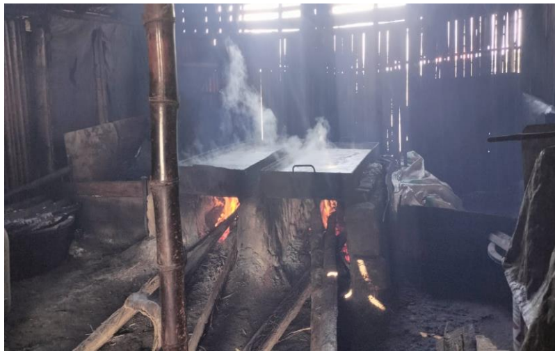
Gambar 3. Proses perebusan air garam dengan bahan bakar kayu sampai menjadi garam yang dibakar selama 8 jam dalam media yang terbuat dari drum bekas.
