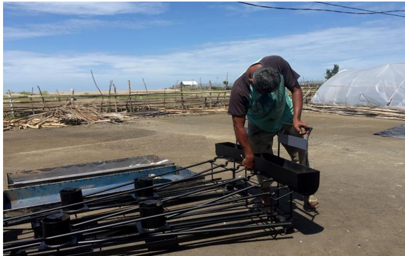
Gambar 5. Kompor bahan bakar oli bekas menggunakan tiga tungku bakar yang diterapkan pada petani garam yang menggantikan bahan bakar kayu dalam proses pembuatan garam.
