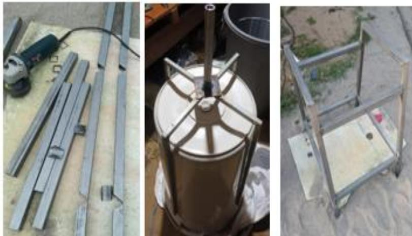
**Gambar 7.** Proses pembuatan alat feed mixer
