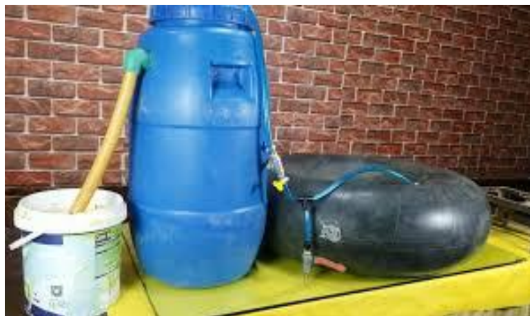
Gambar 4. Prototipe Instalasi Pembuatan Biogas
