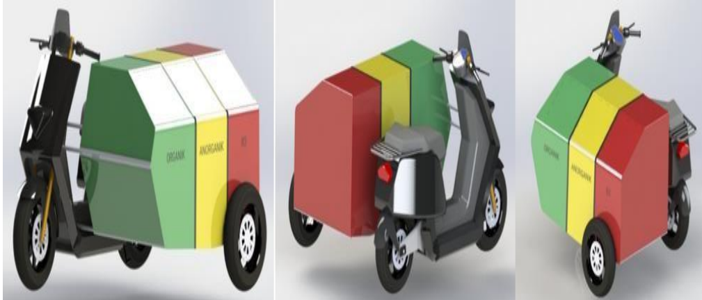
Gambar 2. Desain Ergonomik Cabin sampah Becak Listrik Pengangkut Sampah (Sumber:hasil rancangan Iskandar dan Irfan (FT. Unsyiah) 2023)
