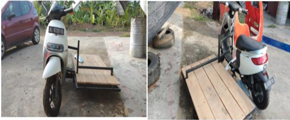
Gambar 3. Pembuatan Cabin Sampah Becak Listrik Pengangkut Sampah
