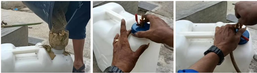
Gambar 5. Proses fermentasi anaerobic, pemasangan katup, dan pemasangan selang
