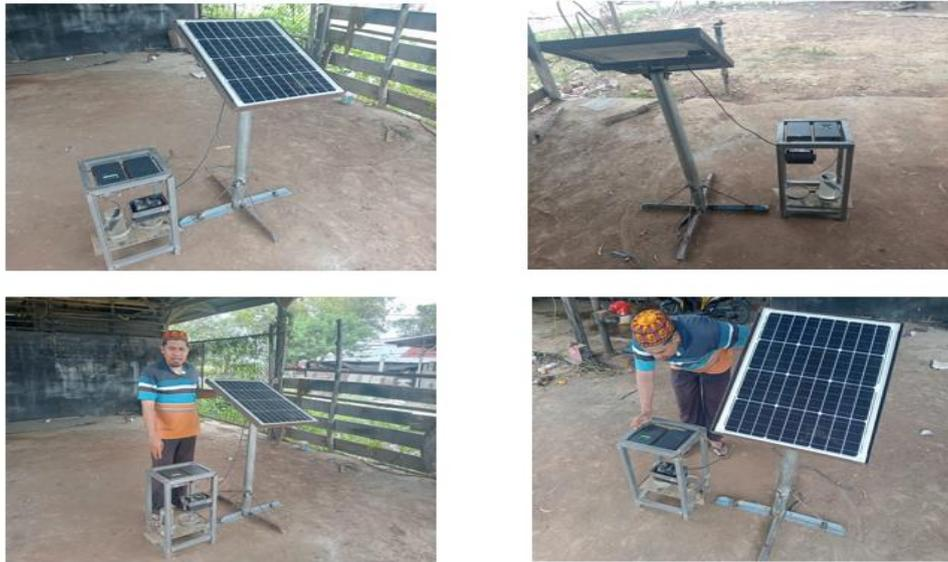
**Gambar 5.** Tahap akhir *finishing* alat pendeteksi kadar ammonia dan pH air tambak berbasis ramah lingkungan.
