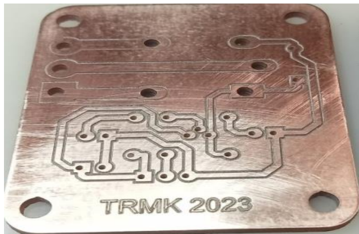
Gambar 8. Hasil etching pembuatan jalur PCB
