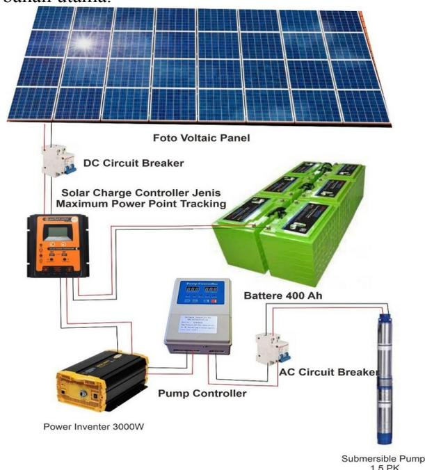
**Gambar 2.** Skematis diagram pemasangan pompa *submersible* pada sistem pengairan memanfaatkan tenaga matahari
