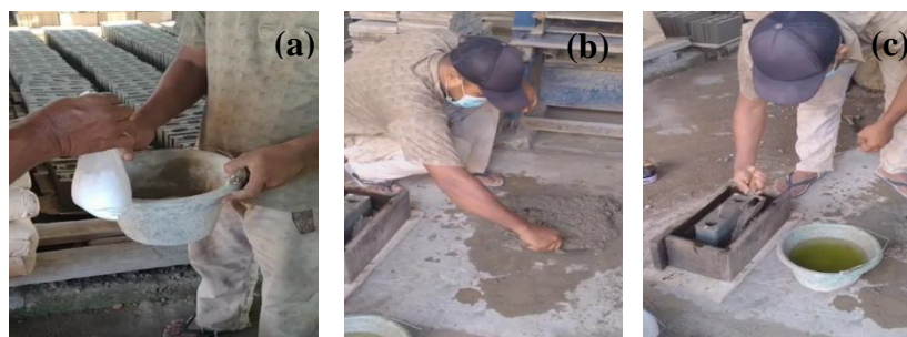
Gambar 5. Proses pembuatan produk berbasis limbah kaca (a) pencampuran semen dengan serbuk kaca, (b) Pencampuran dengan pasir halus dan air, (c) proses pencetakan.
