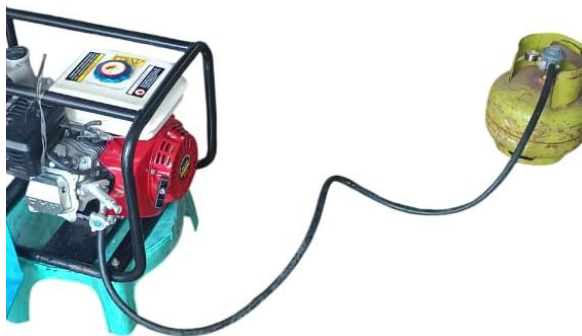
Gambar 3. Karburator modifikasi berbahan bakar gas LPG
