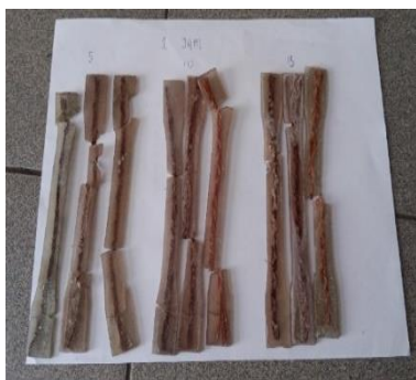
Gambar 3. Spesimen yang sudah diuji
