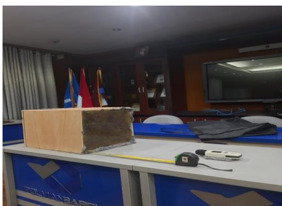
Gambar 2. Skema pengujian absorpsi suara
