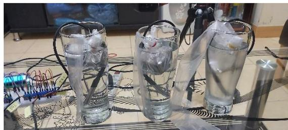
Gambar 6. Spesimen dibungkus dan digantung pada bagian permukaan air di dalam gelas.
