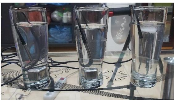
Gambar 5. Posisi sensor termokopel dan spesimen ketika ditempatkan di dalam gelas berisi air.
