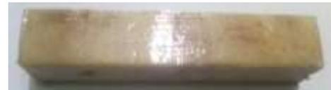
Gambar 4. Spesimen Komposit dengan Serat Sabut Kelapa 20%
