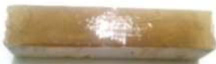
Gambar 3. Spesimen Komposit dengan Serat Sabut Kelapa 10%
