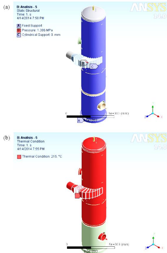
Gambar 9. Pemberian constraint dan load pada bejana tekan siklon separator (a) Kondisi pembebanan pada model (b) Kondisi thermal .
