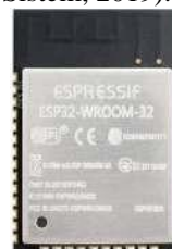
Gambar 2 Bentuk fisik Modul ESP32
