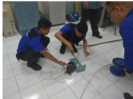
Gambar 5 . Pengelasan pipa tembaga
