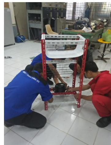
Gambar 6. Pemasangan komponen lemari pendingin pada modul
