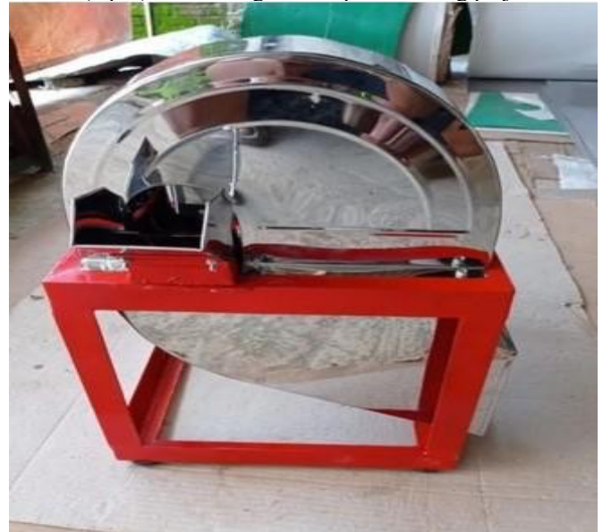
Gambar 6 Mesin Pengiris Bawang[6]
