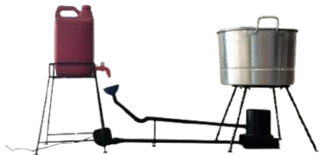
Gambar 2. Rancangan Kompor Oli Bekas yang diterapkan pada mitra UMKM Tuna Crispy Pak Nas
