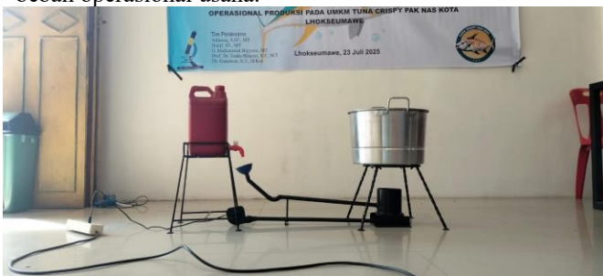
Gambar 3. Kompor Oli Bekas yang diterapkan pada mitra UMKM Tuna Crispy Pak Nas
