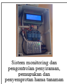
Gambar 4. Instalasi perangkat sistem monitoring dan pengontrolan penyiraman, pemupukan dan penyemprotan hama tanaman berbasis IoT (internet of things)
