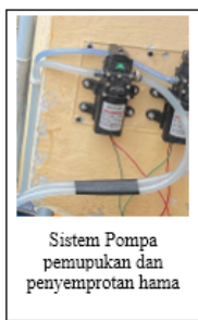
Gambar 4. Instalasi perangkat sistem monitoring dan pengontrolan penyiraman, pemupukan dan penyemprotan hama tanaman berbasis IoT (internet of things)
