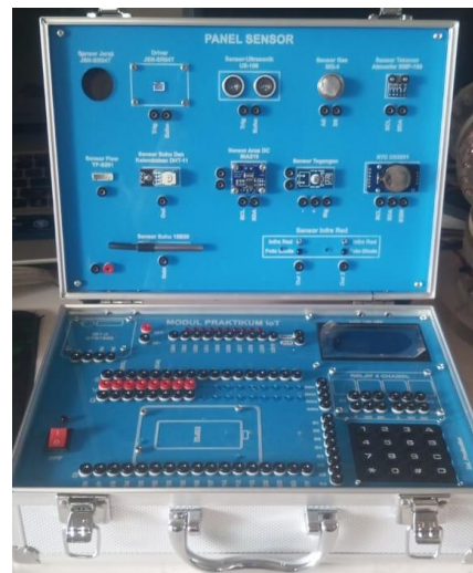
Gambar 1.1. Alat Praktikum IoT yang digunakan untuk Mengukur Sensor Jarak
