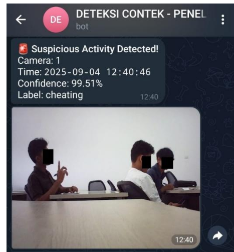
Gambar 10. Contoh notifikasi chatbot Telegram yang berisi bukti yang terekam, hasil klasifikasi, dan metadata.
