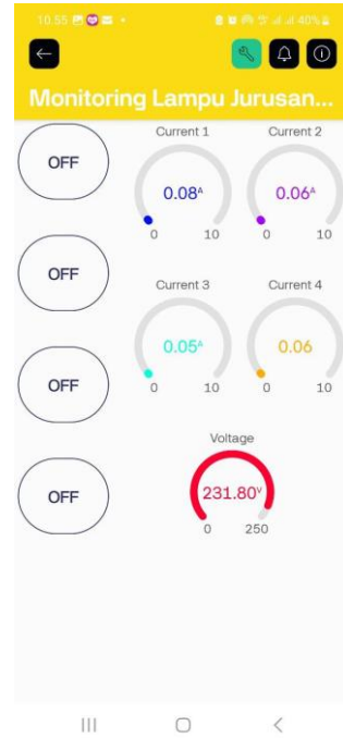
Gambar 5. Hasil Pengujian 4 Lampu Menyala
