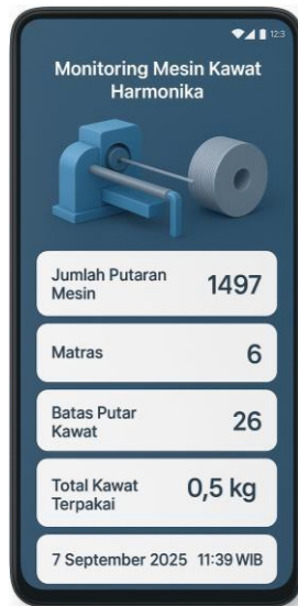
Gambar 6. Tampilan pada perangkat mobile sistem monitoring mesin produksi kawat harmonika
