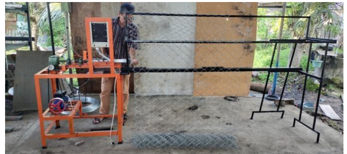
Gambar 5. mesin kawat harmonika yang telah dilengkapi modul kendali IoT
