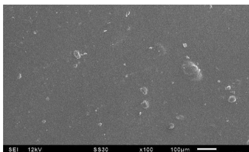
Gambar 4.5. Hasil analisa SEM untuk Nanokomposit Pektin/bentonit/kitosan
