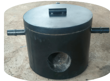
Gambar 12. Hasil dapur peleburan yang sudah di cat
