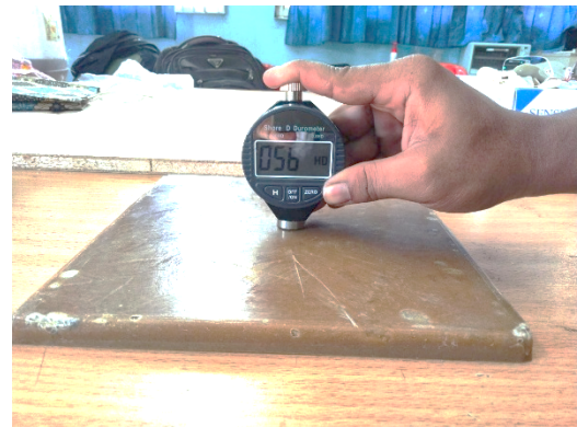
Gambar 2. Proses pengujian kekerasan
