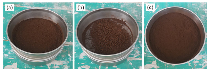
Gambar 2. Pengayakan ampas kopi, (a) sebelum diayak, (b) gumpalan dan kotoran, dan (c) setelah diayak.
