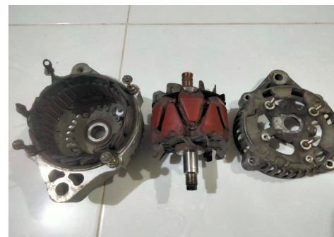
Gambar.1. Kontruksi Alternator Mobil
