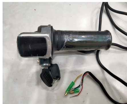
Gambar.6. Throttle Pengatur Kecepatan
