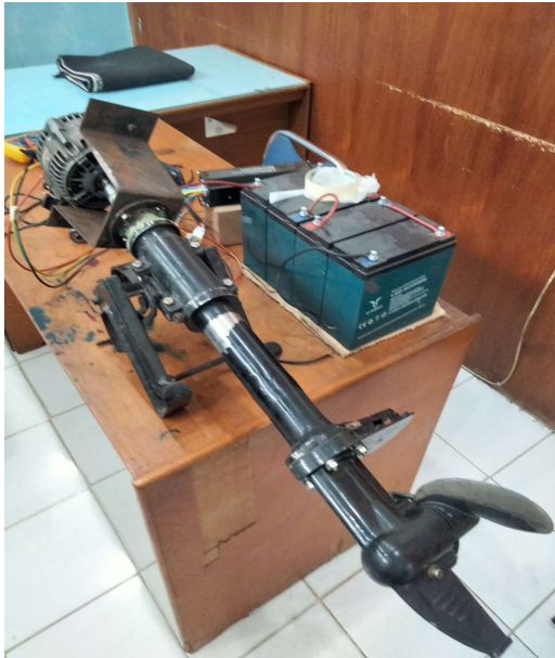
Gambar.12. Gambar pengujian motor BLDC pada outboard mesin tempel
