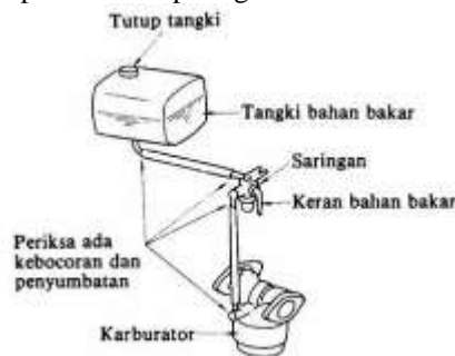
Gambar 2. Beberapa komponen sistem bahan bakar bensin.
