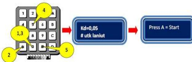
Gambar 7. Urutan langkah memasukan  $K_d$  melalui Keypad pada PID kontroler.
