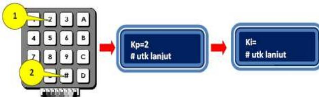
Gambar 5. Urutan langkah memasukan  $K_p$  melalui Keypad pada PID kontroler.
