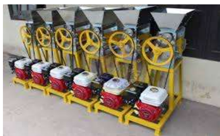
Gambar 1 Mesin pegupas kulit buah kopi yang terdapat dipasaran
