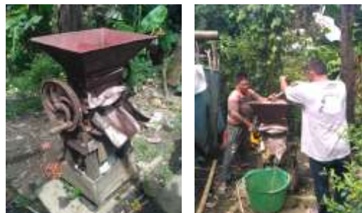
Gambar 2 Mesin pulper yang dimiliki mitra
