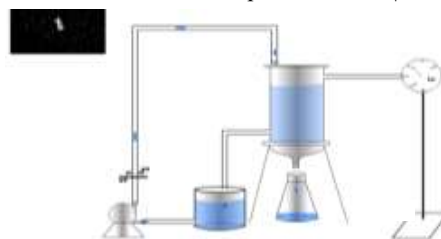
Gambar 1. Skema Proses Filtrasi dan Detail Modul Membran
