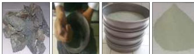
Gambar 2. Proses Pengecilan Ukuran Batuan Zeolite Alam Ujung Pancu, Aceh
