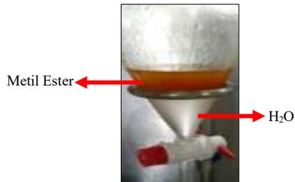
Gambar 6. Produk Metil Ester Saat Proses Purifikasi
