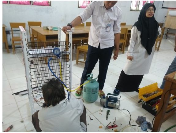
Gambar 9. Penjelasan teknik pengisian refrigerant
