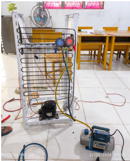
Gambar 8. Pemvacuman sistem pemipaan kulkas
