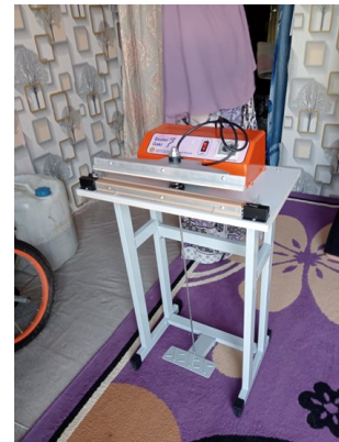
Gambar 2. Alat sealer kemasan yang diterapkan pada UMKM Pak Nas pada kegiatan pengabdian
