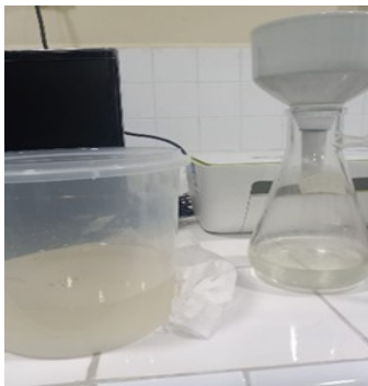
Gambar 1. Minyak VCO yang akan disaring dengan pompa vakum dan corong buchner serta kertas saring
