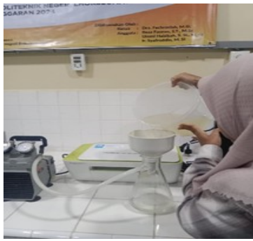
Gambar 4. Mitra melakukan praktek penyaringan vakum
