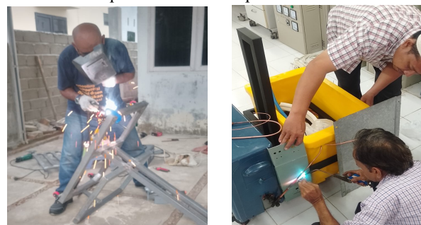
Gambar 1. Proses fabrikasi mesin pembuat es batu cepat (a) pengelasan dudukan mesin, (b) penyambungan kondensator
