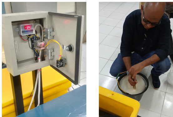
Gambar 2. Proses pengujian mesin pembuat es batu cepat (a) Setting temperatur, (b) pembuatan larutan pembeku
