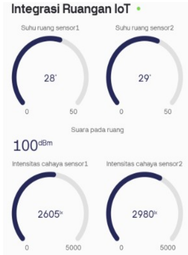
Gambar 5. Hasil pengujian pemantauan tingkat kebisingan ruangan, pencahayaan dan suhu pada dua lokasi yang berbeda menggunakan blynk iot
