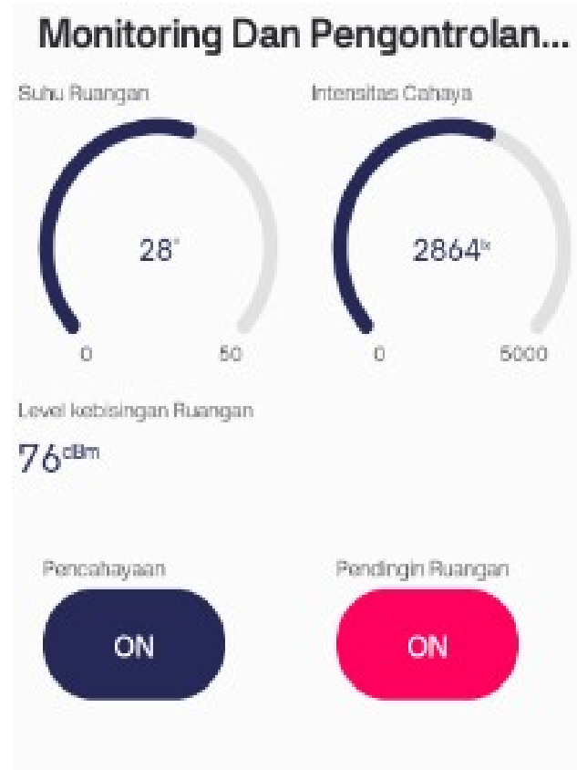
Gambar 6 Hasil pengujian pemantauan tingkat kebisingan ruangan, pencahayaan dan suhu dan pengontrolan lampu dan alat pendingin menggunakan blynk iot
