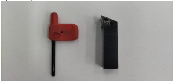
Gambar 3. Mata pahat yang kanan dengan insert tool karbida
