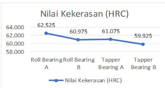
Gambar 6. Grafik Nilai Rata-Rata Hasil Pengujian Kekerasan di Konversi Kesatuan (HRC).
