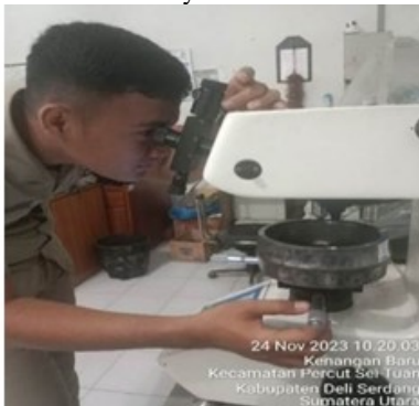
Gambar 2. Pengujian Kekerasan Sampel
