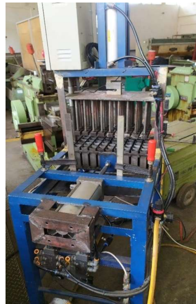
Gambar 10. Mesin press briket yang dapat bekerja secara otomatis dan manual
