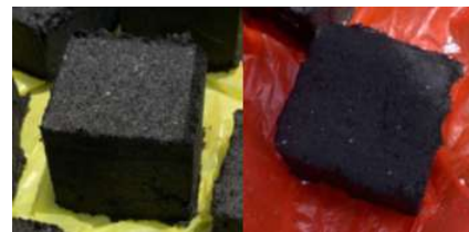
Gambar 14. Biobriket berbahan dasar serat ampas tebu dengan perekat organik
