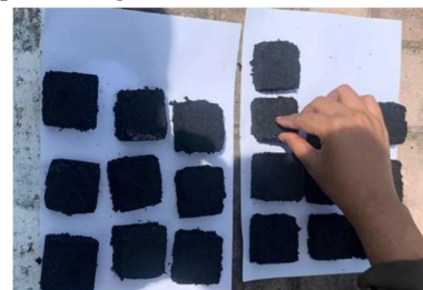
Gambar 13. Biobriket berbahan dasar serat tandan kosong kelapa sawit dengan perekat organik dan anorganik yang dihasilkan mesin press
