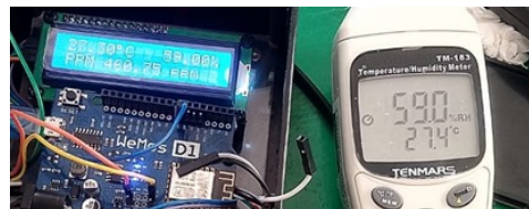
Gambar 9. Pengujian pengukuran sensor kelembaban DHT22 menggunakan pembanding TENMARS TM-183
