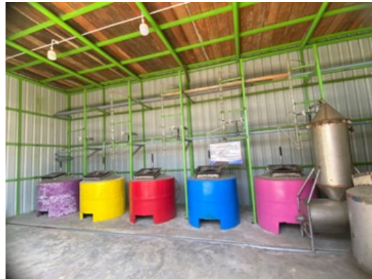
Gambar 1. Alat Distilasi Uap
