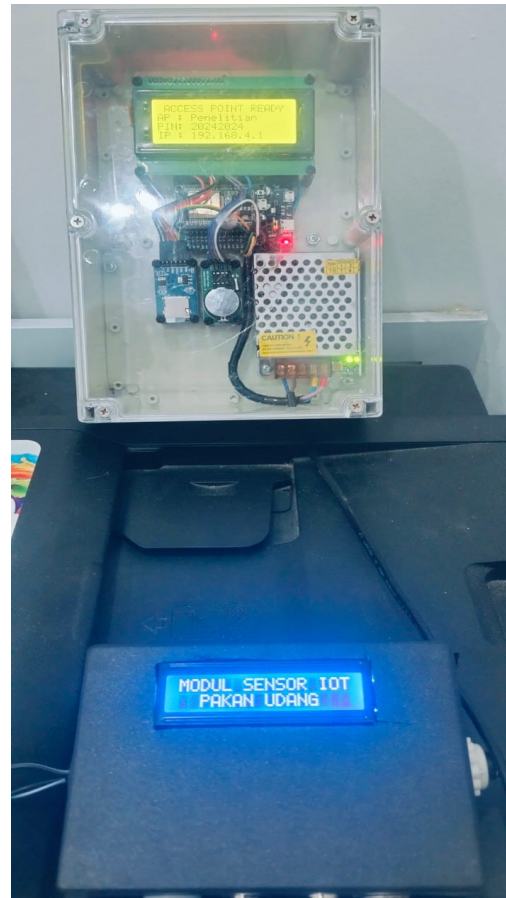
Gambar 8. Modul sistem pengendalian pemberian pakan udang vaname berdasarkan pemantauan kondisi air kolam udang vaname berbasis IoT
